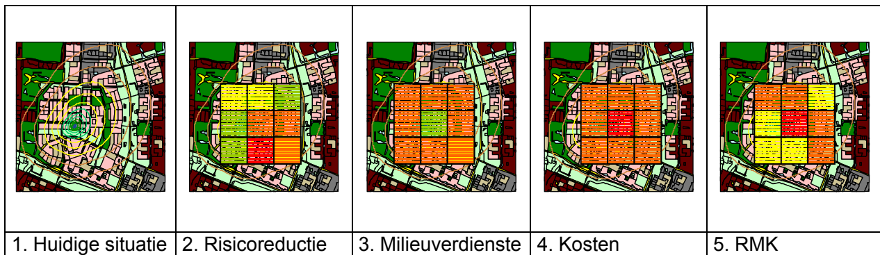
Fig. A3. Voorbeeld van de uitvoer van de quick-scan in kaartvorm (RMK-kaart) na de sanering.
